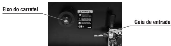
Figura 4 – Montagem do rolo de arame
